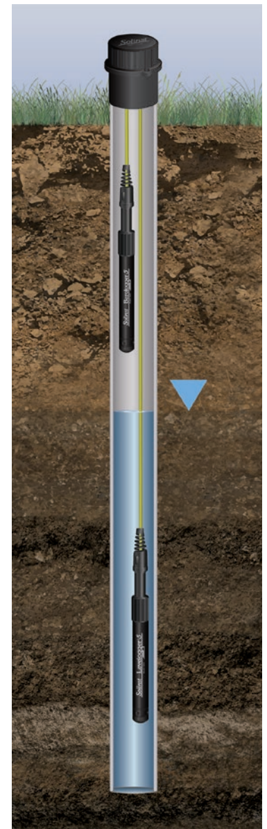
Barologger 5 y Levelogger 5 instalados en pozo usando cables de lectura directa L5
