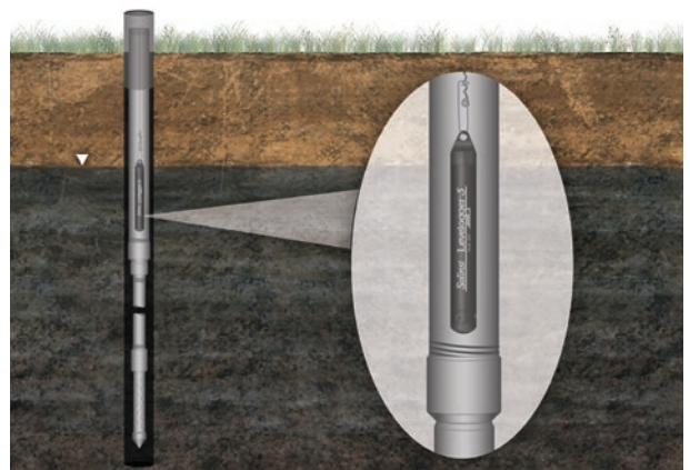
Instalación del Levelogger justo por debajo del nivel de agua más bajo de lo esperado
