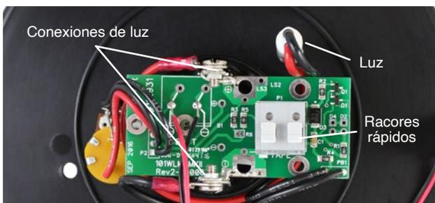
Parte posterior de la miniplaca frontal del medidor de nivel de agua Mk2 modelo 102M con luz de estilo antiguo
