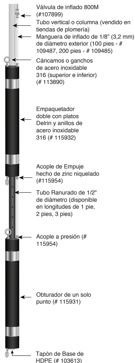
Configuración estándar de obturador doble con líneas de inflado
