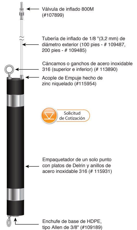
Configuración estándar de empaque de un solo punto con línea de inflado (la manguera y la válvula de inflado no se incluyen con el empaquetador)
