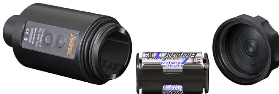
Figura 2-2 Instalación/reemplazo de las baterías de la App Interface de Levelogger 5
