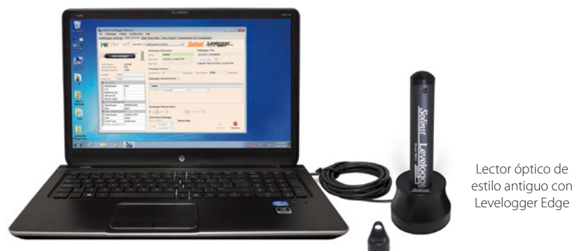
Figura 2-5 Levellogger Edge conectado a una PC usando un lector óptico de estilo antiguo
