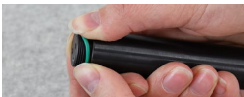
Figura 10-26 Reemplazo de las juntas tóricas dañadas del Levelogger
