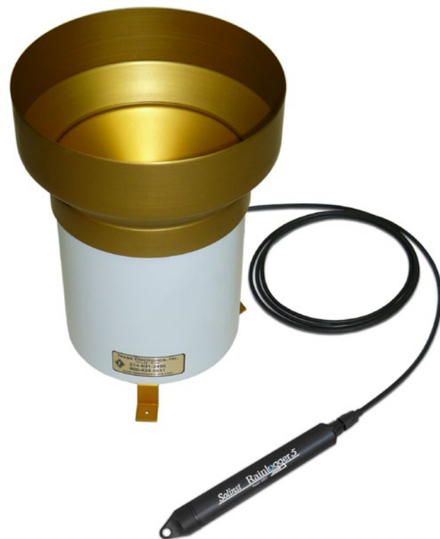
Figura 10-21 Rainlogger 5 conectado al balancín
