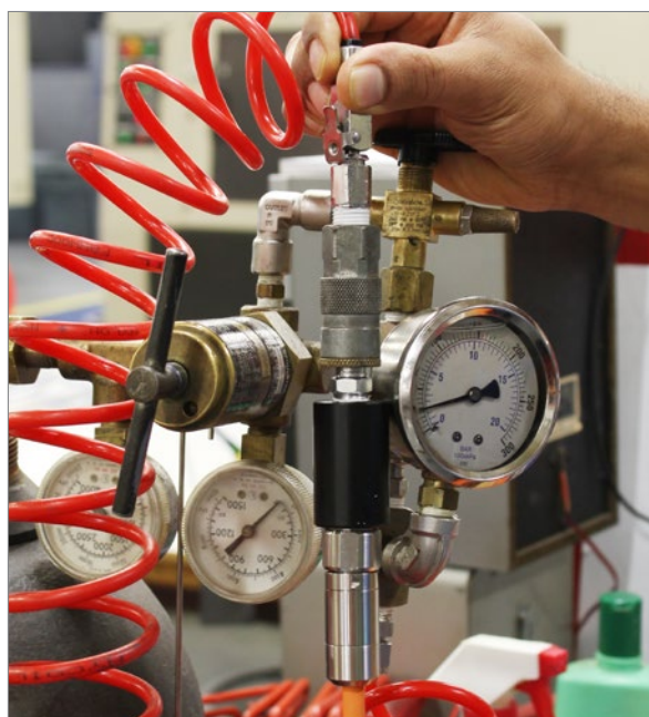
Figura 9-6 Gas de nitrógeno soplado a través del cable venteado
