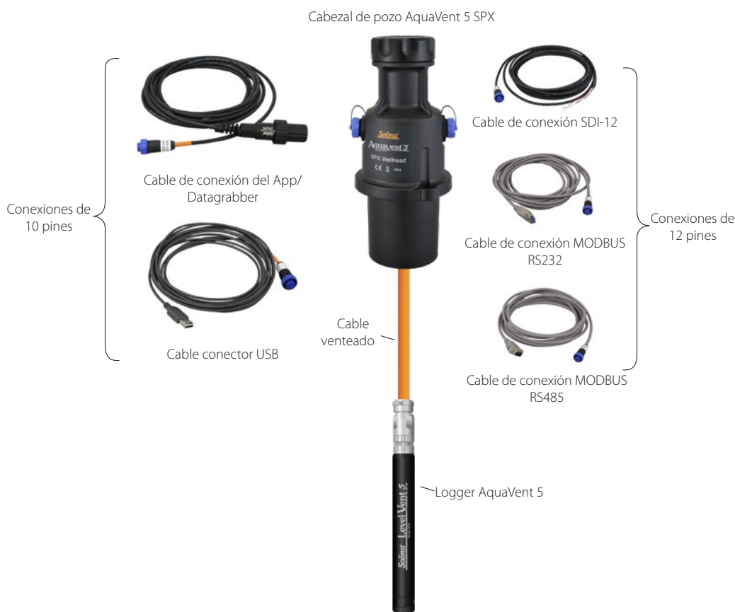
Figura 1-8 Sistema AquaVent 5 completo
