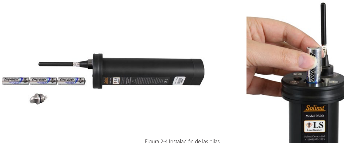
Figura 2-4 Instalación de las pilas
