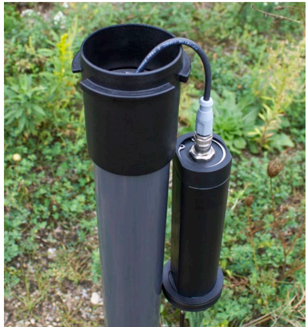
Figura 6-7 Conecte el cable lector al LevelSender
