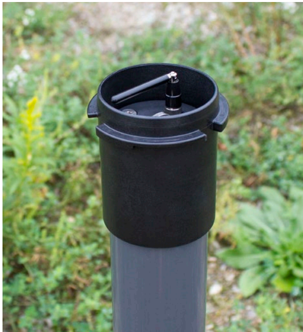
Figura 6-9 Instale el tapa pozos
