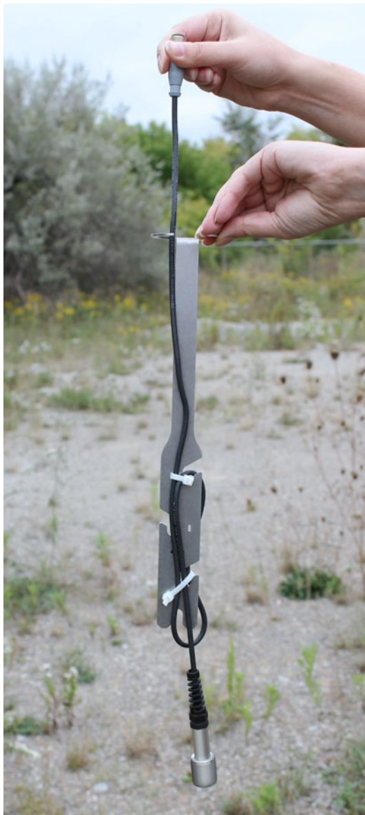
Figura 6-4 Asegure el cable de lectura al soporte colgante de sujeción
