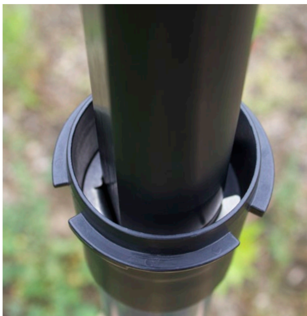
Figura 6-8 Baje el LevelSender hacia su posición
