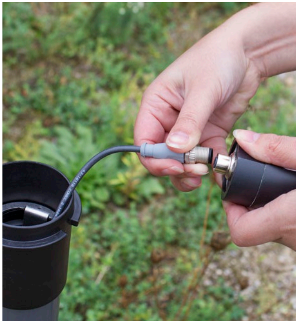
Figura 6-7 Conecte el cable lector al LevelSender
