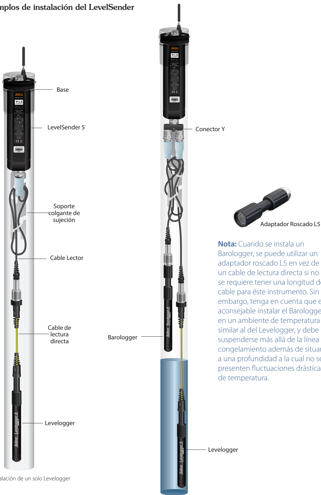
Figure 6-11 Instalación del Levellogger y el Barologger (con las conexiones del cable de lectura de forma escalonada)
