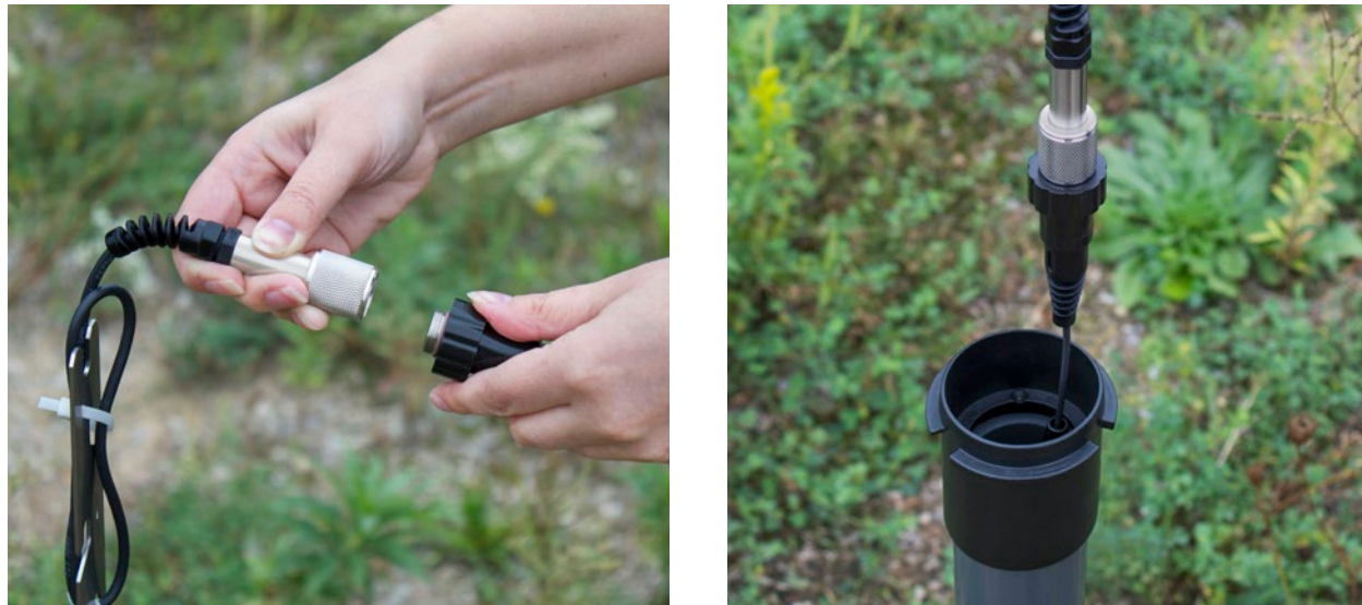
Figura 6-5 Conecte el cable de lectura directa y el Levellogger
