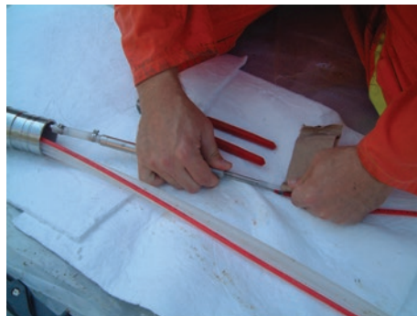
Figura 6-12 Uso de papel de lija para empujar tubería dentro del vástago de la bomba
