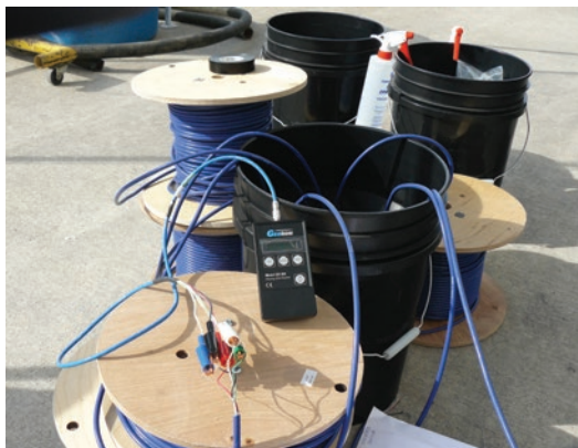
Figura 6-6 Sumerja previamente los transductores de cuerda vibrante
