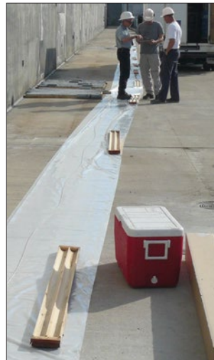
Figura 4-1 Disposición de plástico y cable de soporte SS (aquí se usan cajas con núcleo de madera para pesar el plástico)
