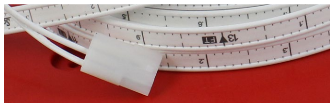
Retirez les broches du connecteur Molex du ruban plat (Mk1)
