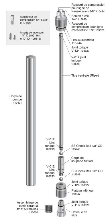
(Retenue de filtre et assemblage d'écran (complet 110517)
