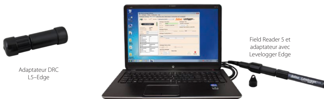
Figure 2-4 Levellogger Edge connecté à un PC à l'aide d'un adaptateur DRC Edge-L5 et d'un lecteur de terrain 5
