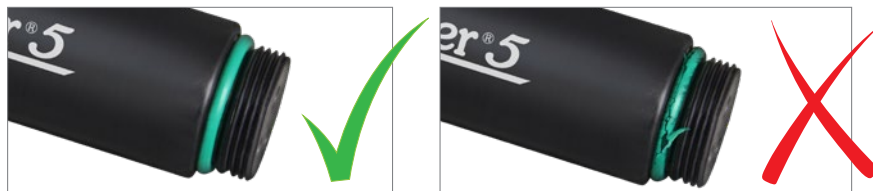
Figure 10-25 : Dommages aux joints toriques du Levelogger
