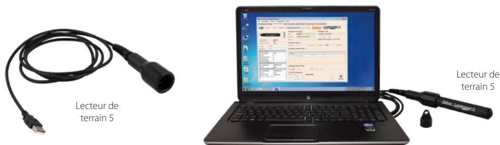
Figure 2-2 : Levelogger 5 raccordé à un PC à l'aide d'un lecteur optique Field Reader 5
