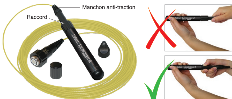
Figure 10-14 : Manière correcte de retirer un câble à lecture directe d'un Levelogger
