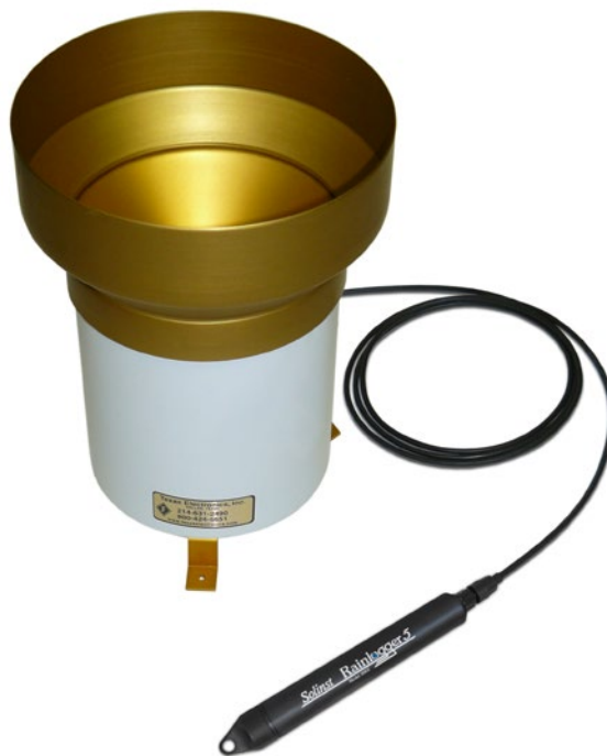
Figure 10-21 : Rainlogger 5 raccordé à un auget basculeur
