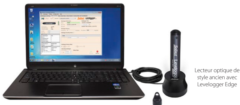
Figure 2-5 Levellogger Edge connecté à un PC à l'aide d'un lecteur optique de style plus ancien
