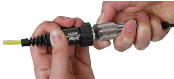
Figure 3-1 Connexion de l'enregistreur de niveau
