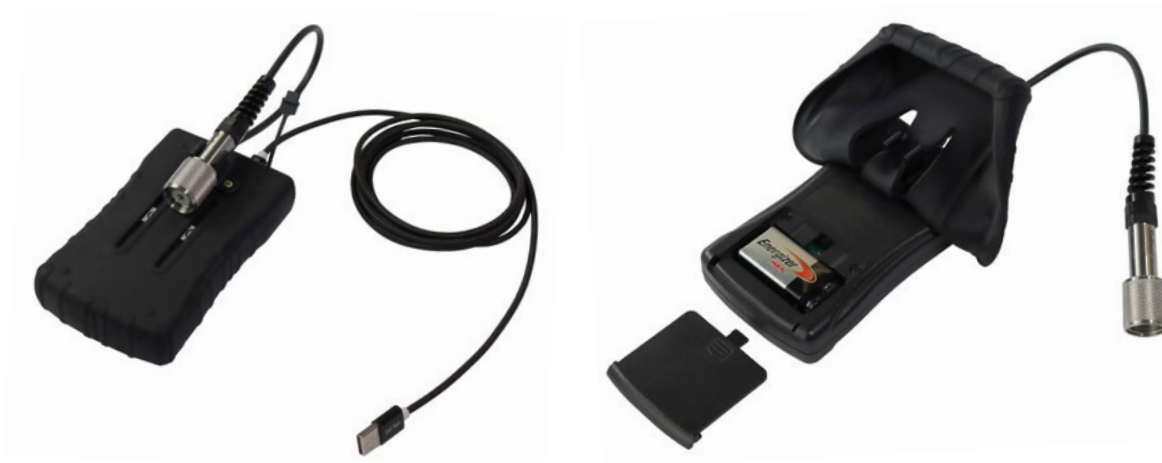
Figure 8-1 Installation de la batterie SRU
