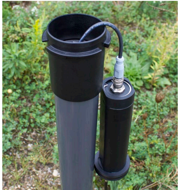
Figure 6-5 : Branchement du câble de lecture directe et du Levellogger
