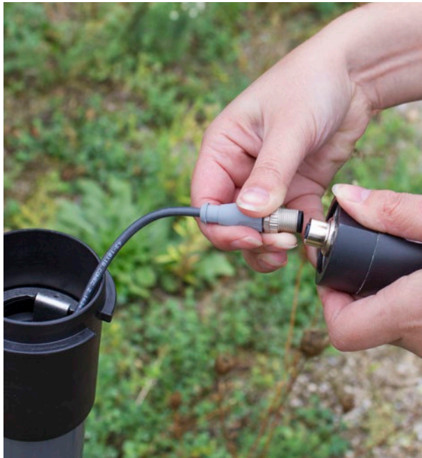
Figure 6-5 : Branchement du câble de lecture directe et du Levellogger
