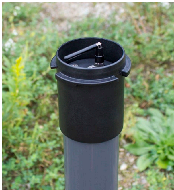
Figure 6-7 : Branchement du câble lecteur au LevelSender
