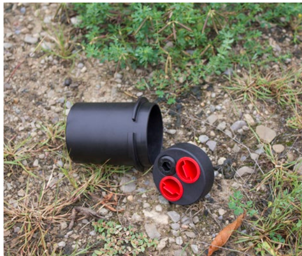
Retrait de l'insert du couvercle de puits de la base du couvercle du puits
