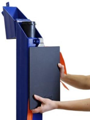
2. Fixez la table de terrain montée sur puits à l'aide des deux sangles de serrage autour du tubage/enceinte du puits.
